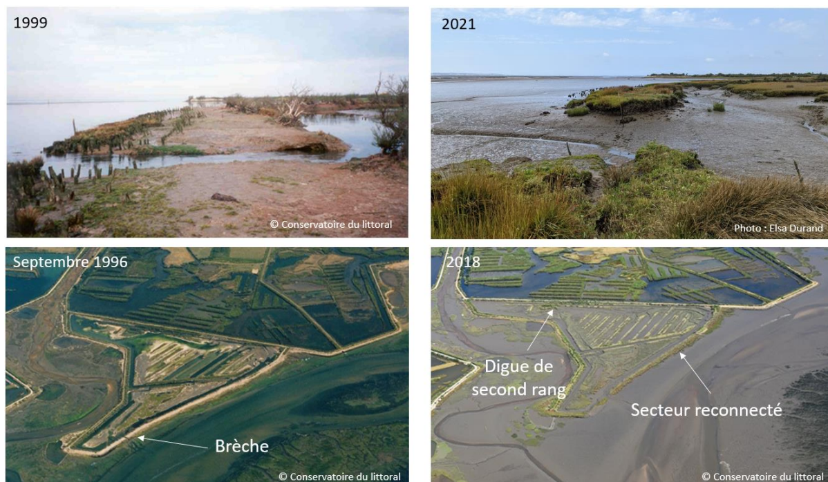
Figure 37 : Evolution de l'ouverture de la brèche de Graveyron entre 1999 et 2021 (en haut) et de l'installation du pré salé entre 1996 et 2018 (en bas)
