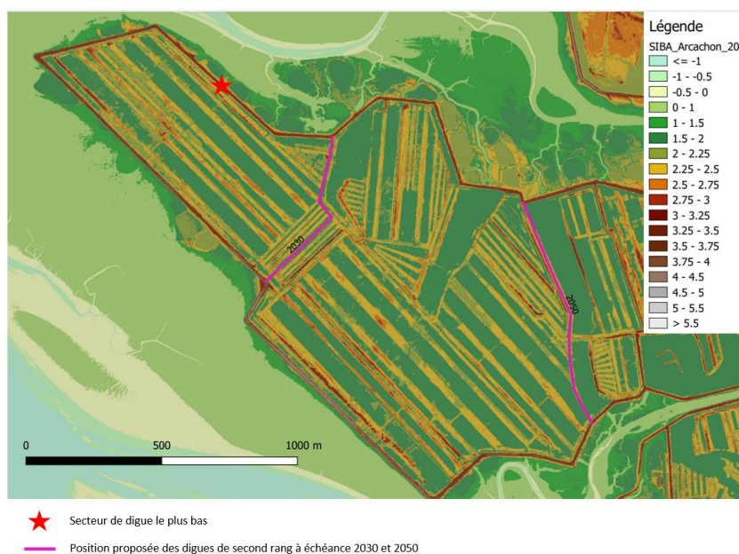
Figure 40 : Proposition de position des digues de second rang dans le cas du scénario de reconnexion marine de la pointe de Branne (d'après Brivois, 2021)
