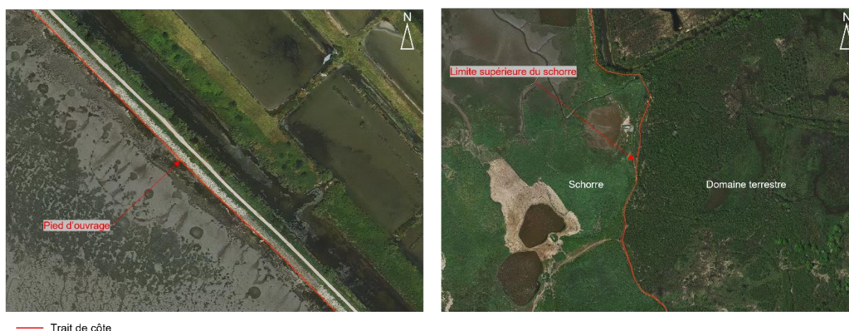
Figure 13 : Illustration des indicateurs de position du trait de côte utilisés dans le cas des domaines endigués (à gauche) et des marais maritimes (à droite)
