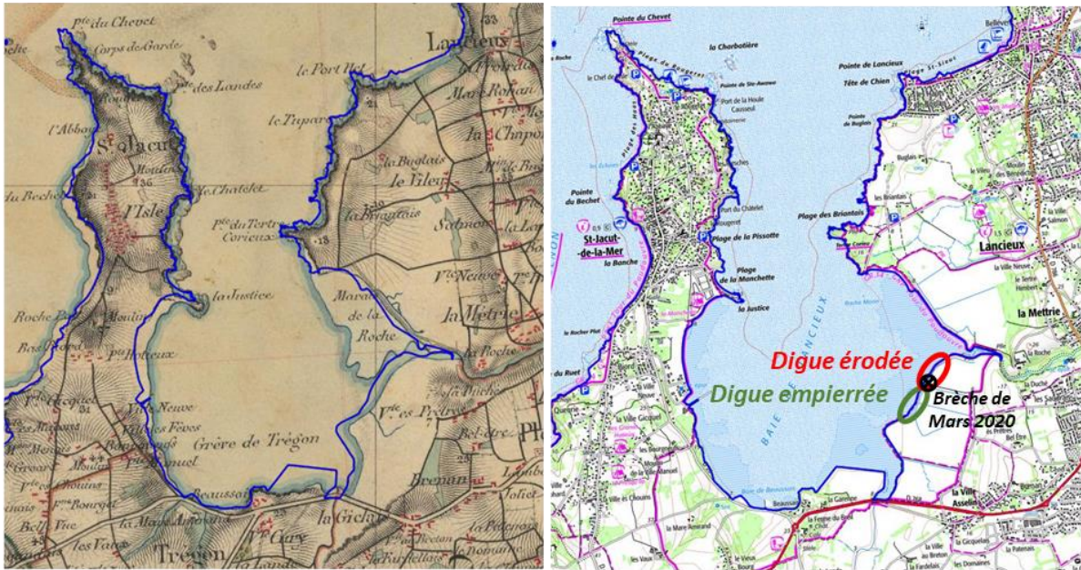
Illustration 7 – Aperçu de la Baie de Lancieux et des polders de Lancieux et Ploubalay sur la carte d'Etat-Major (entre 1820 et 1866) et la carte topographique actuelle (d'après www.geoportail.gouv.fr ) ; le trait bleu représente le trait de côte actuel Histolitt (©Shom) ; à droite, les zones vertes et rouges représentent respectivement les secteurs empierrés et érodés, la cible noire représente l'emplacement de la brèche apparue en Mars 2020.
