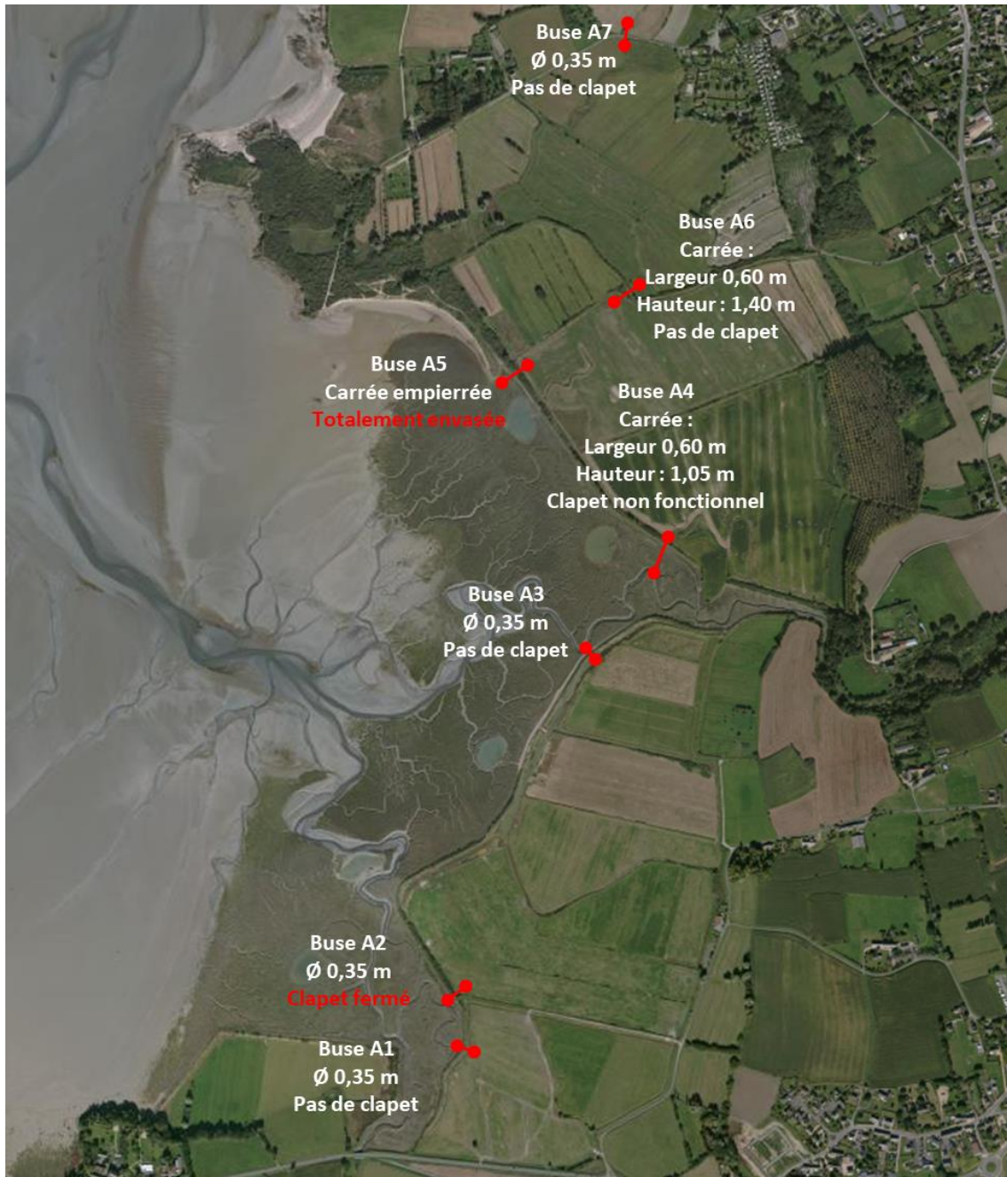
Illustration 57 – Positions et caractéristiques des connexions hydrauliques intégrées dans les simulations.
